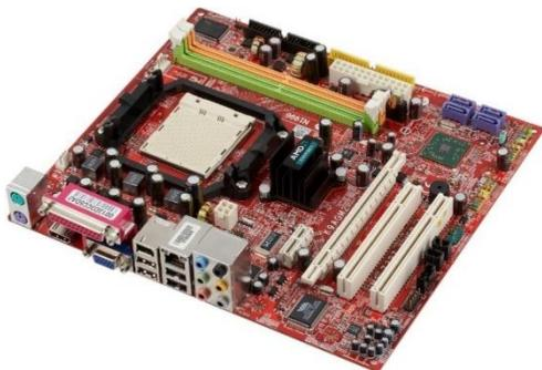
**Placa madre (o motherboard).** Es la placa principal de cualquier sistema informático al que todos los demás dispositivos se conectan, tanto de manera directa (como los circuitos eléctricos interconectados) como indirecta (a través de puertos USB u otro tipo de conectores).
