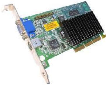
**Placa de video.** También conocida como "tarjeta gráfica" es un dispositivo de hardware interno que se conecta a la placa madre y permite que la computadora muestre imágenes en el monitor. Requiere de la instalación de un software para que le indique a la computadora cómo usar esa placa de video
